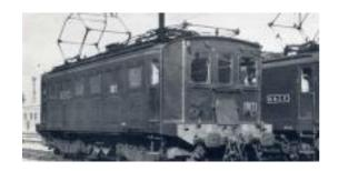
Les BB 1 à 80 sont des locomotives électriques de l'ancienne compagnie Paris-Orléans, reprises par la SNCF à sa création. Il s'agit d'une série faisant partie des 200 locomotives pour service mixte commandée par le réseau d'Orléans lors de l'électrification de la ligne Paris - Vierzon.
